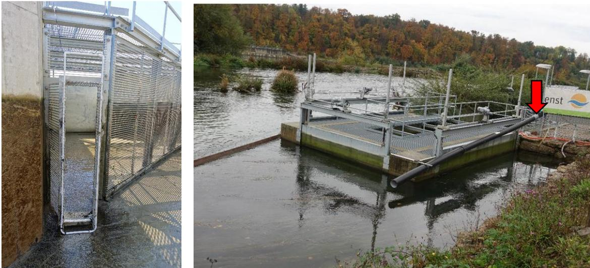
**Abbildung 4:** Links: Antenne beim Einstieg in das Zählbecken auf der deutschen Seite. Rechts: Antenne am Rohr (roter Pfeil), über welches die gezählten Fische in den Rhein zurückgegeben werden.
