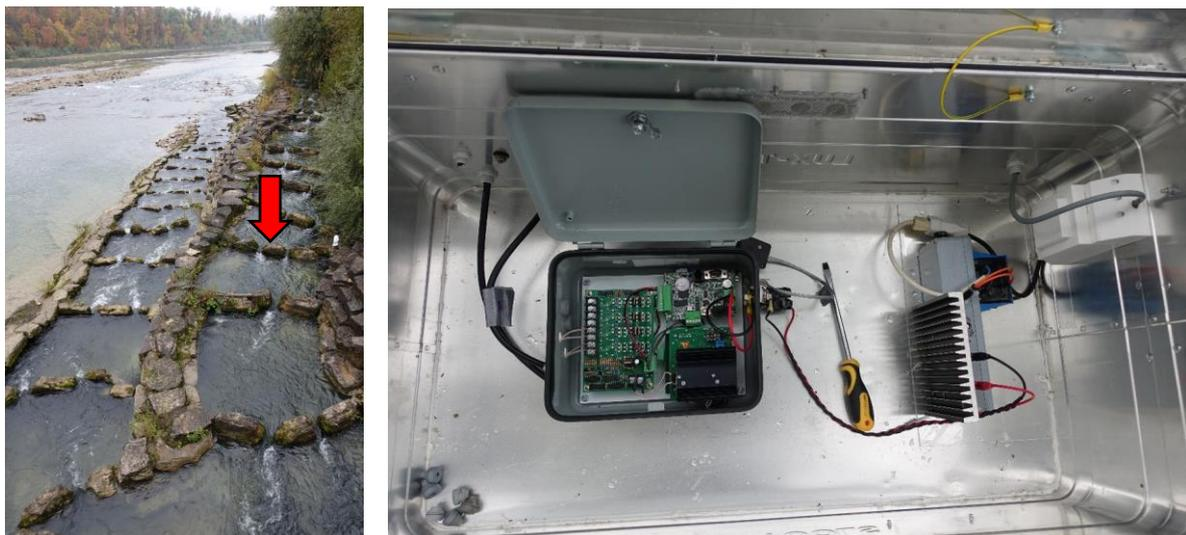
**Abbildung 3:** Links: Der Standort der unteren Antenne im Raugerinnebeckenpass ist mit dem roten Pfeil markiert. Rechts: Aluminiumkiste mit Reader und zwei Antennenkabeln.
