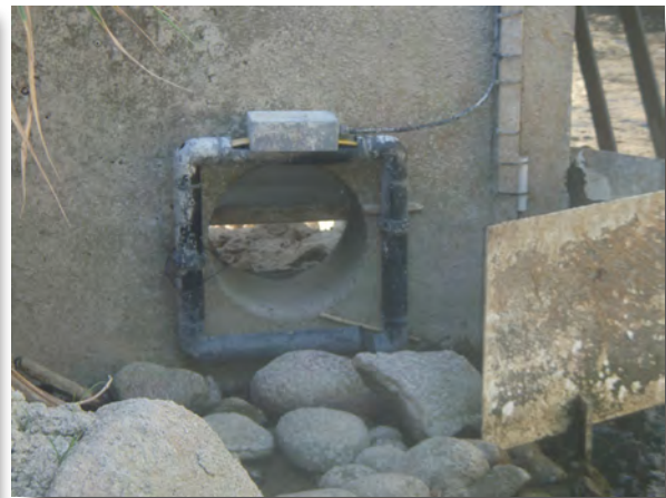
Abbildung 18: RFID-Antennen im Oberwasserkanal zum Wasserwirbel (links) und am Ausgang aus der Fischschleuse (rechts).
