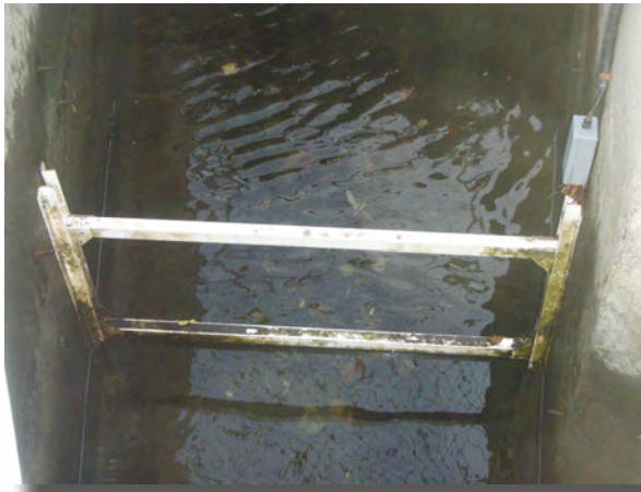
Abbildung 18: RFID-Antennen im Oberwasserkanal zum Wasserwirbel (links) und am Ausgang aus der Fischschleuse (rechts).
