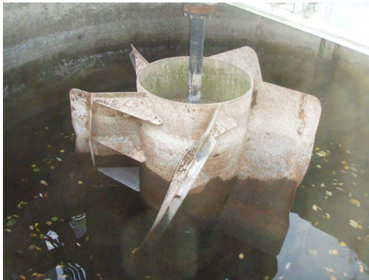
Abbildung 24: Der Rotor des Wasserwirbelkraftwerks Schöffland am 28.10.2015 bei Stillstand wegen Niederwasser.,
